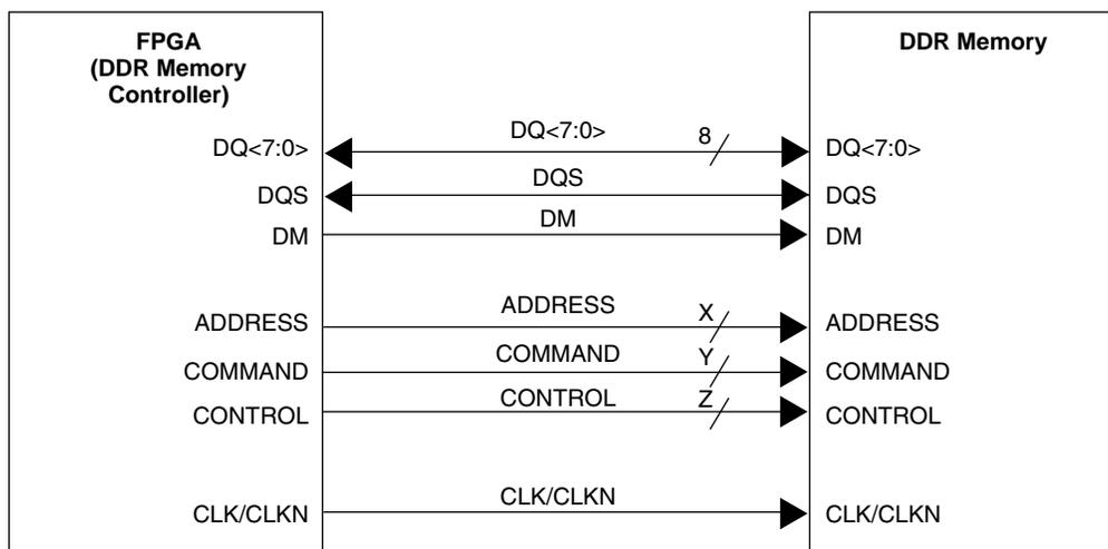
Figure 10-2. DQ-DQS During READ
