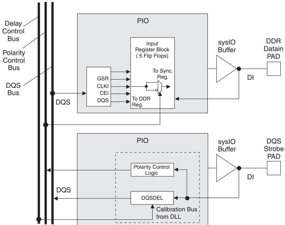
Figure 2-33. DLL Calibration Bus and DQS/DQS Transition Distribution
